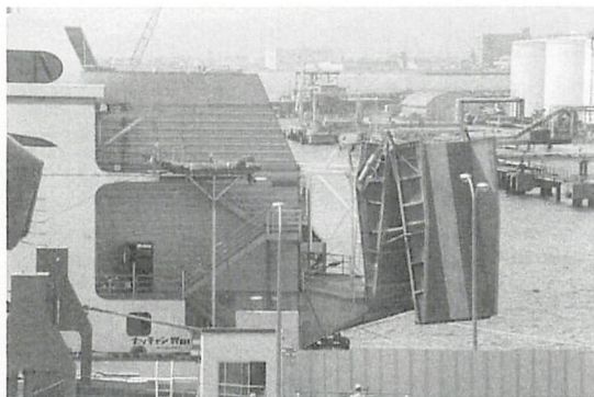
「ナッチャンWorld」の左舷船尾に増設されたランプウェイ
